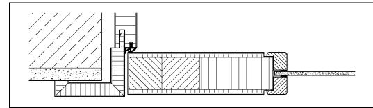
Wohnraumtür Standard, mit Lichtausschnitt und flächenbündigen Glasleisten, mit Basis-Zarge B70, stumpf einschlagend
